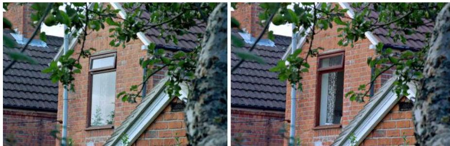
Fotografías tomadas a una ventana con una cámara con un filtro polarizador rotado en dos ángulos diferentes. A la izquierda, el polarizador está alineado con el ángulo de polarización de la reflexión de la ventana. A la derecha, el polarizador fue rotado 90°, eliminando la reflexión de la luz polarizada del sol.
